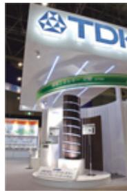
TDKのフィルムタイプのアモルファスシリコン太陽電池をオブジェにしつらえた発電タワーです。フレキシブルなうえ独自のロールtoロール工法により、長尺製品も一貫生産できるのが、TDKの太陽電池の特長です。
