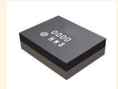
チップサイズパッケージ技術を導入し、小型化を実現した2016サイズデュプレクサ。携帯電話の小型化・低背化に貢献しています。
