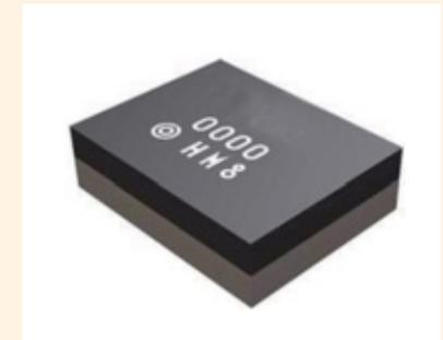
チップサイズパッケージ技術を導入し、小型化を実現した2016サイズデュプレクサ。携帯電話の小型化・低背化に貢献しています。
