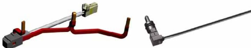
xEVモータの温度を測るセンサであるフラットコイル一体型の小型モータサーミスタは、新規の小型構造体を開発することで、高い応答性と耐久性を持つ製品です。製品が使用される環境を考慮した寸法精度が高いフラットコイルの加工やフォーミングの設備導入、自動化は難易度が高いチャレンジでしたが、試行錯誤の末その壁を乗り越え、最終的には生産性が高く品質が安定した生産ラインを導入したほか、かかわったメンバーのスキルアップや連携力強化にもつながりました。
