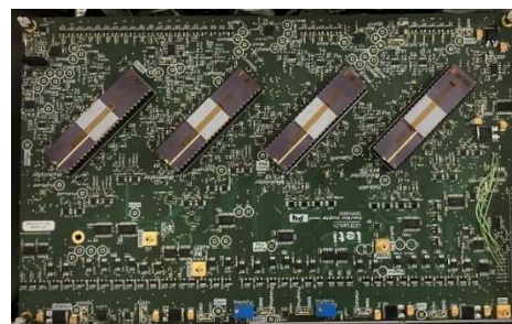
セラミックパッケージを4つ搭載したAI回路基板
