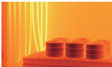
フェライトの焼成工程と温度制御
