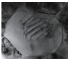
誘電体セラミックス粒子のコア(中央部)・シェル(周辺部)構造
