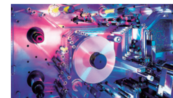
フィルムコンデンサの製造に使われる高速・高精度の自動巻回機
