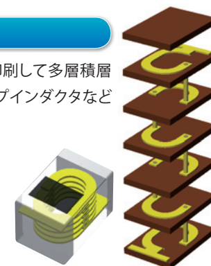
積層チップインダクタの構造 積層技術により、立体的らせん状のコイルをチップ内部に形成します。
