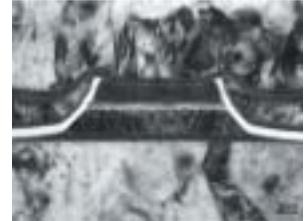
TMR(トンネリングMR)ヘッドの電子顕微鏡写真
