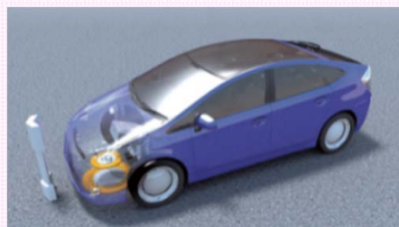
車両充電用 非接触給電デバイス
