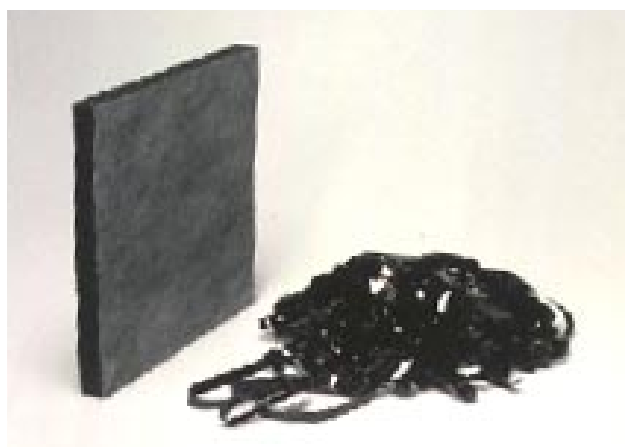
型枠パネル(左)と材料の廃磁気テープ(右)
