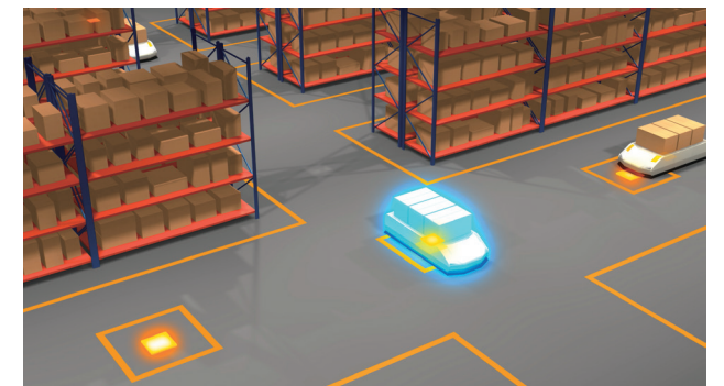
磁界共鳴方式のワイヤレス給電。 無人搬送車、物流ロボットなどの産業機器向け。
